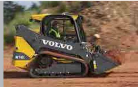
Dank des hydraulischen Volvo Geräteträgers, kann der Fahrer das Anbaugerät vom Sitz aus wechseln
