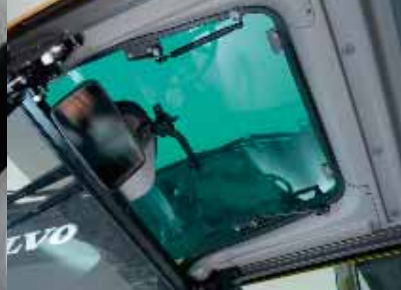
• Aufstellbares Dachfenster mit Gasfederstütze.
