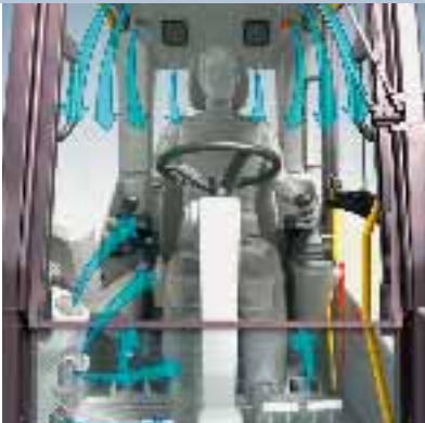
Elektronisch gesteuerte Klimatisierung
