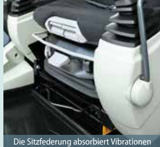
Die Sitzfederung absorbiert Vibrationen
