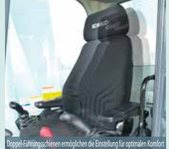
Doppel-Führungsschienen ermöglichen die Einstellung für optimalen Komfort
