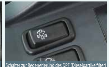
Schalter zur Regenerierung des DPF (Dieselpartikelfilter)
