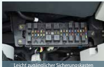
Leicht zugänglicher Sicherungskasten
