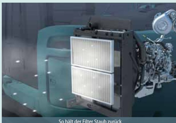
So hält der Filter Staub zurück
