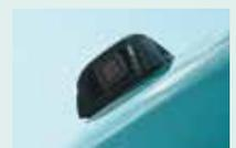
Eine Rückfahrkamera ist zur einfachen Sicherheitskontrolle des Bereichs hinter der Maschine serienmäßig installiert. Das Bild erscheint auf dem Farbmonitor.
