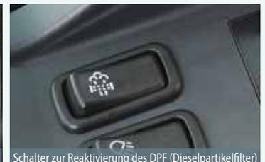
Schalter zur Reaktivierung des DPF (Dieselpartikelfilter)
