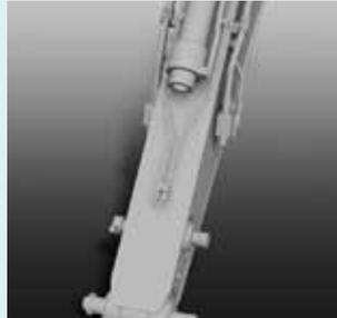
Optional ist eine separate Hydraulikleitung für einen Schnellwechsler erhältlich, der den Wechsel des Anbaugerätes beschleunigt.
