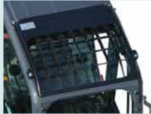
Dach-Schutzgitter Stufe II (erfüllt ISO10262)
