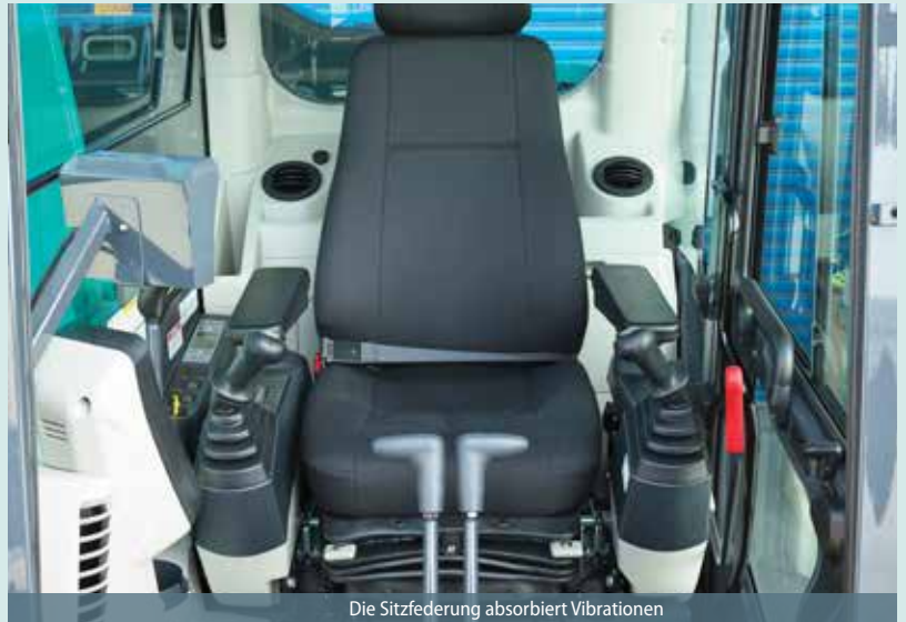
Die Sitzfederung absorbiert Vibrationen
