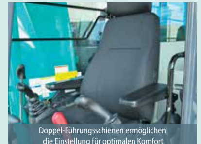
Die Sitzfederung absorbiert Vibrationen
