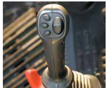
Joysticks mit Proportionalsteuerung für Anbaugeräte
