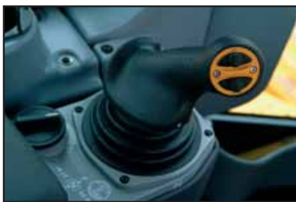
Linker Joystick für Fahrfunktionen
